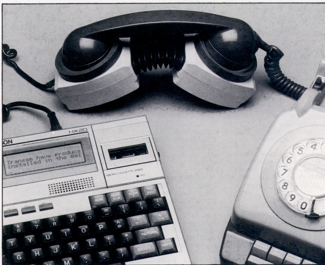
Un coupleur acoustique comme celui-ci relie un ordinateur au réseau téléphonique.
